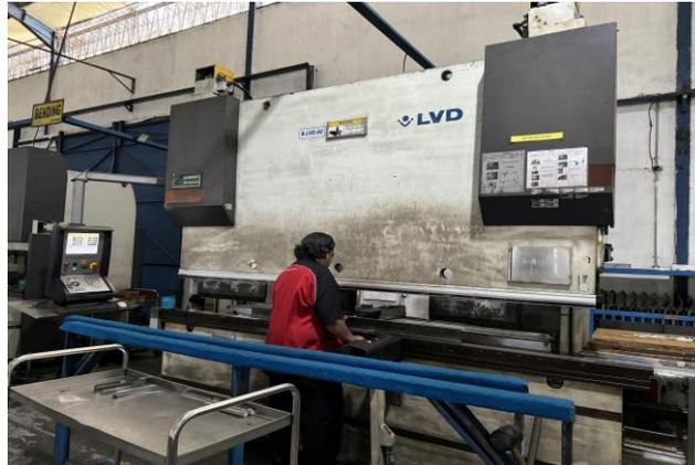
Gambar 4.h Mesin *bending*
