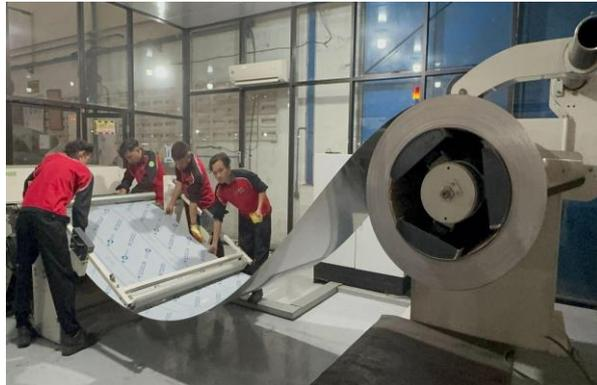
**Gambar 4.f** Proses *uncoiling*
