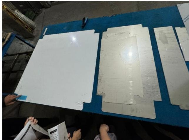
Stainless Steel setelah melalui mesin laser
