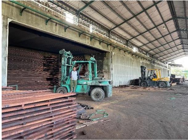
Gambar 1.4 Proses Memasukkan Kayu dalam Mesin Kedi
