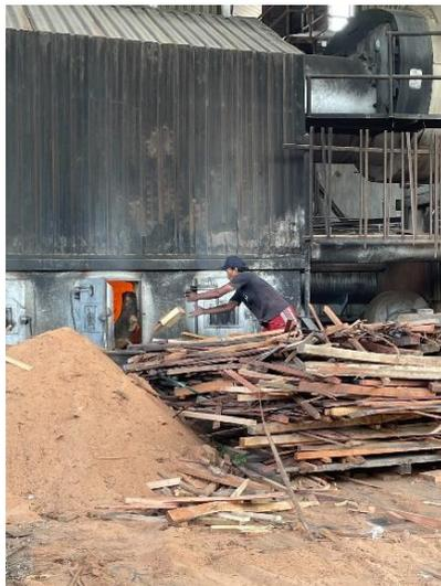
Gambar 1.8 Memasukkan Kayu dalam Mesin Boiler
