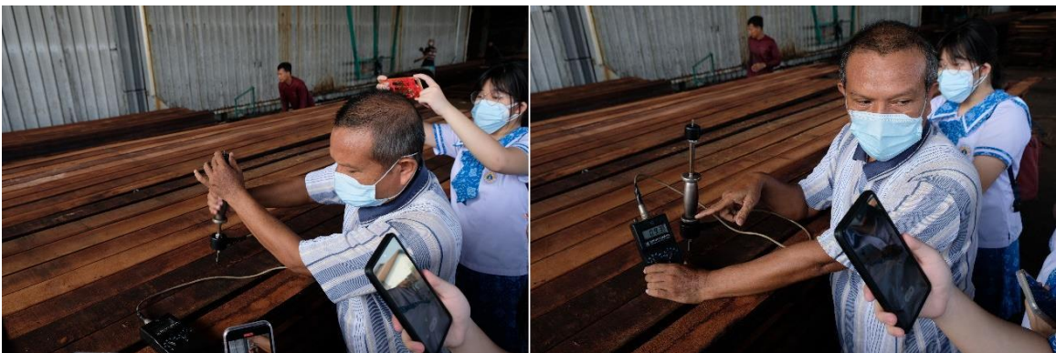
Gambar 6.9 Pengujian Kelembapan Kayu
