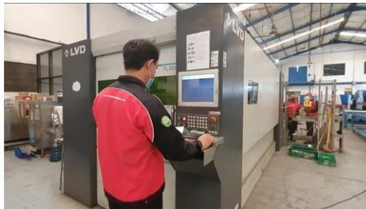
**Gambar 4.g** Proses *input* spesifikasi produk ke dalam mesin pemotong laser.
