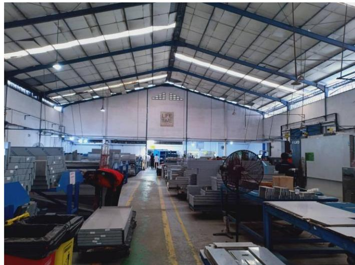
**Gambar 4.r** Pencahayaan menggunakan atap transparan pada gedung pabrik PT Caterlindo.
