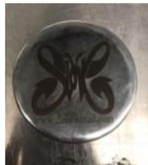
Gambar 4.e Hasil *etching* dengan mesin *laser cutting*
