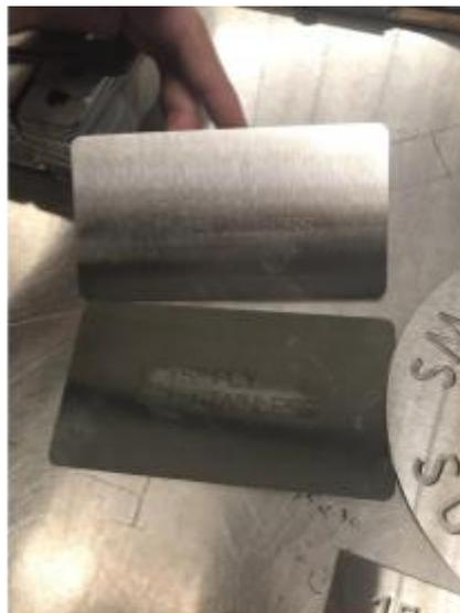
Gambar 4.g Perbandingan plat besi yang melalui proses *etching* tanpa menggunakan oksigen (atas) dan menggunakan oksigen (bawah).
