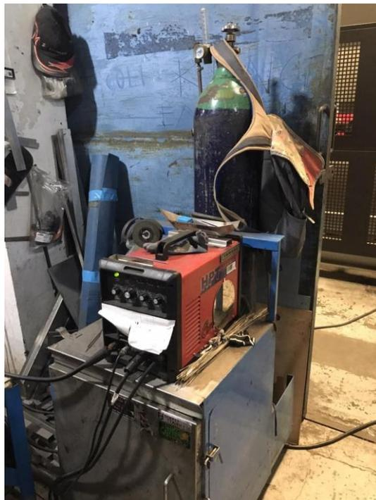
Gambar 4.h Mesin ampere dan tabung gas argon
