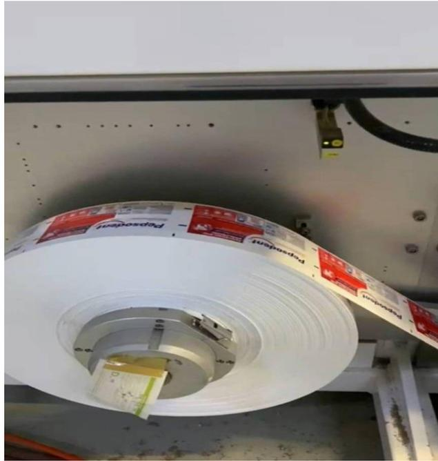
**Gambar 5** Proses Penguluran *Web Print*
